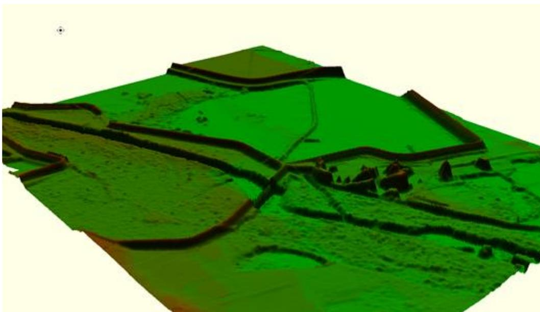
Figura 11 - Casse di laminazione del fiume Secchia su DTM ufficiale 2015
