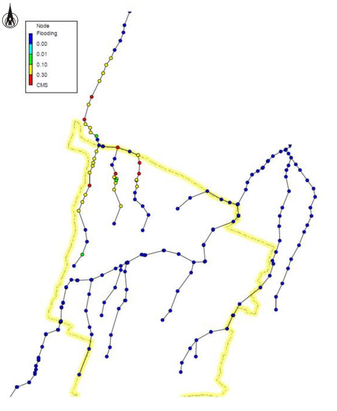
Figura 15 - Esiti delle verifiche idrauliche
