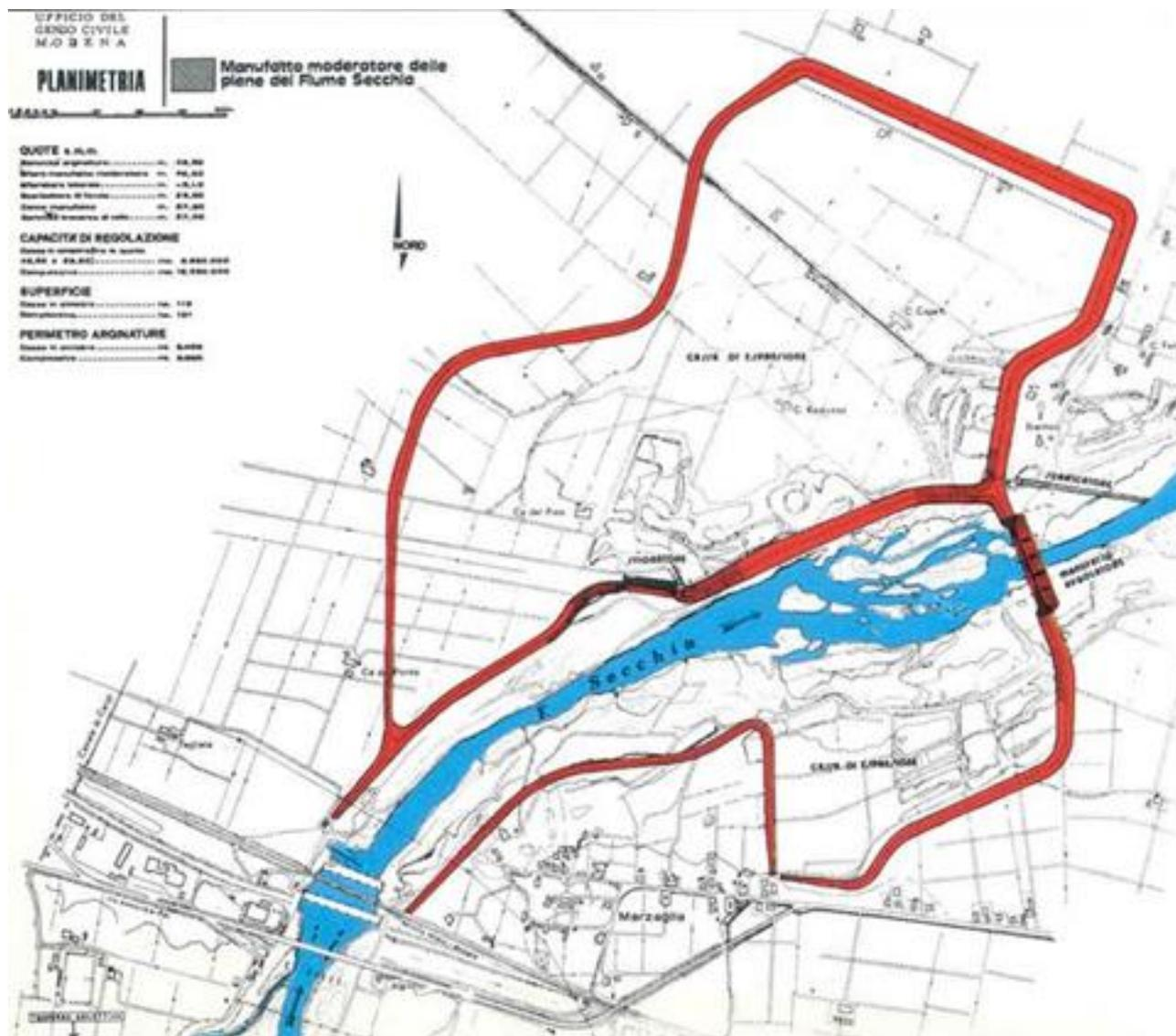
Figura 10 - Schema delle casse di espansione
